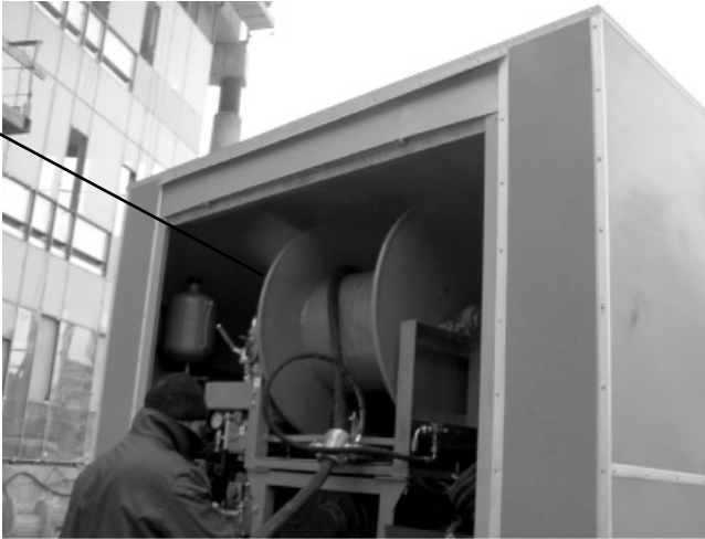
Рис. 12. Гідромонітор на базі вантажного автомобіля "МАЗ": 1-установка гідромонітора
